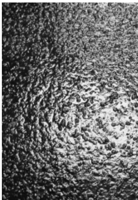
Fig. 17: Ce revêtement en asphalte coulé présente une rugosité trop élevée et entraîne donc une usure trop importante des onglons.
