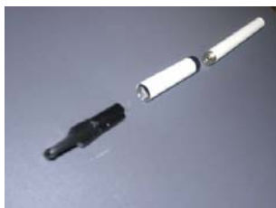
Bocchino con cartuccia di nicotina ricambiabile, modulo di nebulizzazione e accumulatore (da sinistra a destra).
