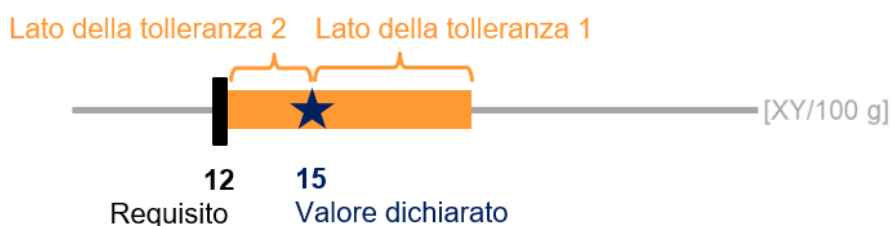
Figura 4: esempio di caso (a): per l'indicazione «fonte di vitamina C» è stabilito il requisito minimo di 12 mg di vitamina C per 100 g di prodotto. Nel caso presente è dichiarato un valore di 15 mg/100 g. Margine di tolleranza secondo la tabella 3: + 50 % (lato della tolleranza 1) e – 20 % (lato della tolleranza 2, incertezza di misura).
