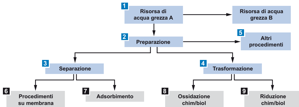
Figura 25: Albero decisionale per classificare nuovi procedimenti per il trattamento di sostanze in tracce. Nella relativa lista di controllo sono elencate le informazioni necessarie per presentare la domanda di autorizzazione.
