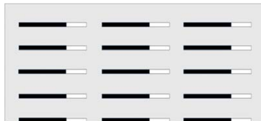
Toutes les fentes partiellement bouchées
