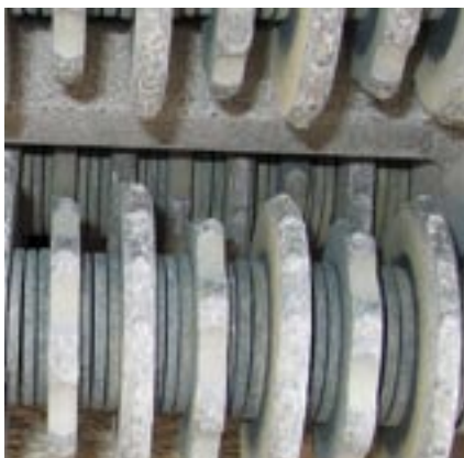
Fig. 4a: La combinaison de lamelles rondes et octogonales permet un rainurage ciblé et un décapage simultané des surfaces intermédiaires.
