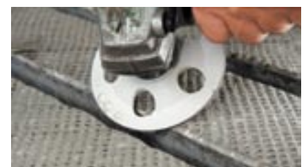
Fig. 17: Les arrêtes des fentes qui ont été endommagées doivent être réparées avec les outils correspondants. L'enlèvement de matériau des deux côtés des fentes augmente la largeur de ces dernières d'au moins 5 mm.
