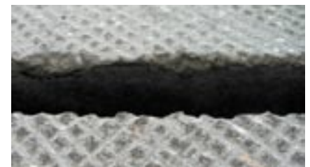
Fig. 16: Le fraisage de la totalité des surfaces de caillebotis fait éclater les arêtes des fentes. Or, les arêtes acérées et les parties saillantes représentent un important risque de blessures pour les ongles.
