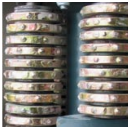
Fig. 5a: L'utilisation de lamelles rondes permet un rainurage fin et évite les éclats du béton.
