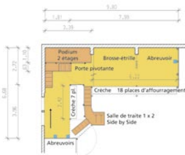
Fig. 3: Exploitation 3: rayon de deux étages monté dans le coin (a) et plan de l'étable (b). La flèche indique l'angle sous lequel a été prise la photo.
