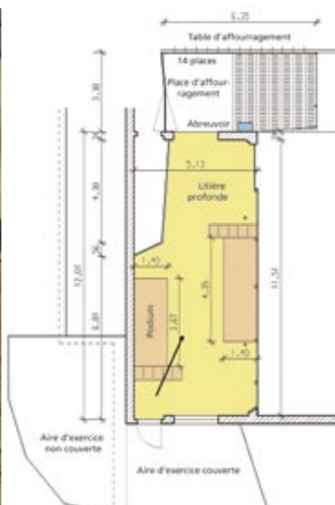
Fig. 1: Exploitation 1: niveau surélevé avec planche inclinée en guise de rampe d'accès (a) et plan de l'étable (b). La flèche indique l'angle sous lequel a été prise la photo.
