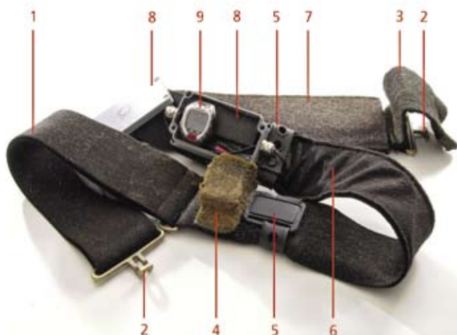
Fig. 4 a) : Structure de la ceinture permettant d'enregistrer la fréquence cardiaque; 1) ceinture élastique; 2) fermeture avec 3) support en feutre; 4) éponge; 5) surface de contact supplémentaire; 6) gaine en tissu avec fil à l'intérieur; 7) cache en feutre; 8) boîtier en aluminium avec couvercle; 9) récepteur Polar S810i.
