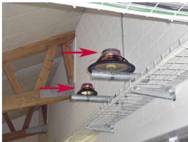
Fig. 1: Systèmes de haut-parleurs permettant de produire du bruit et des vibrations d'une intensité définie.
