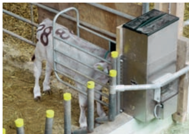
Fig. 6: Les distributeurs automatiques de concentrés permettent d'enregistrer précisément la consommation alimentaire et de calculer la quantité de lait nécessaire pour un apport quotidien en énergie adapté aux besoins de l'animal.
