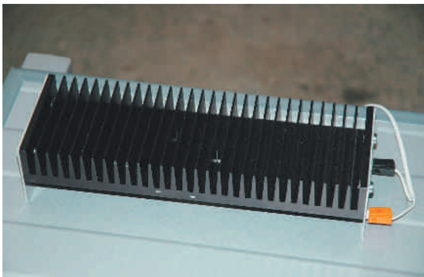
Fig.5 : «Porcelet» artificiel composé d'un élément chauffant en aluminium (0–30 W).
