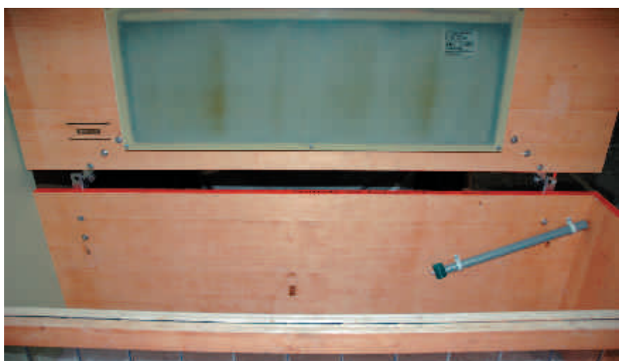
Fig. 4: Nid classique ouvert (plaque chauffante 290 W). Les parois sont faites de panneaux de coffrage.
