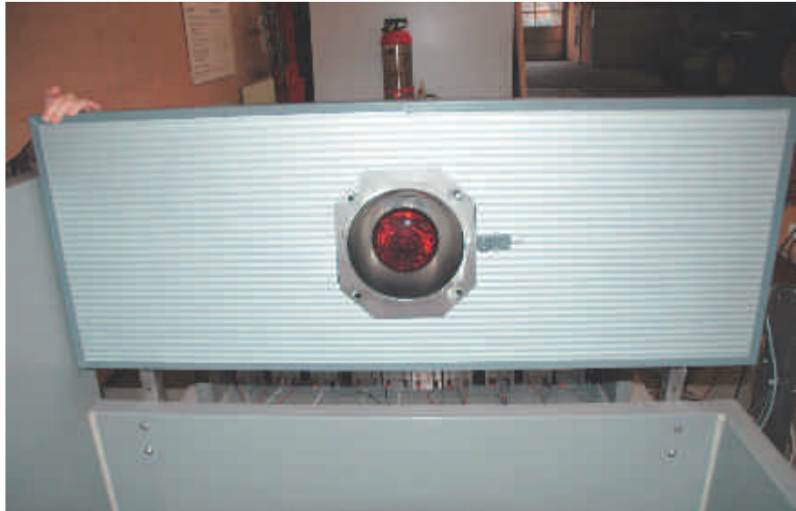
Fig. 2: Nid Isonest IR ouvert. A droite, à côté de la lampe infrarouge (150 W), on distingue le capteur IR.
