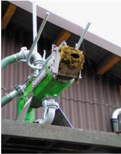
Fig. 4: Le lisier brut est séparé à l'aide d'un compacteur à vis (à gauche). L'idéal est d'épandre la fraction solide immédiatement. Pour ce faire, il faut veiller à ce que l'accès soit libre (à droite).
