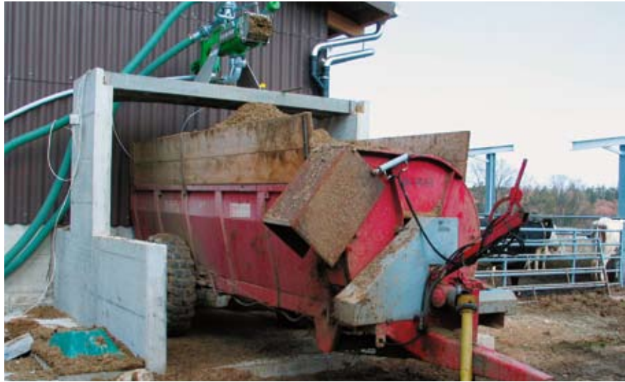
Fig. 4: Le lisier brut est séparé à l'aide d'un compacteur à vis (à gauche). L'idéal est d'épandre la fraction solide immédiatement. Pour ce faire, il faut veiller à ce que l'accès soit libre (à droite).
