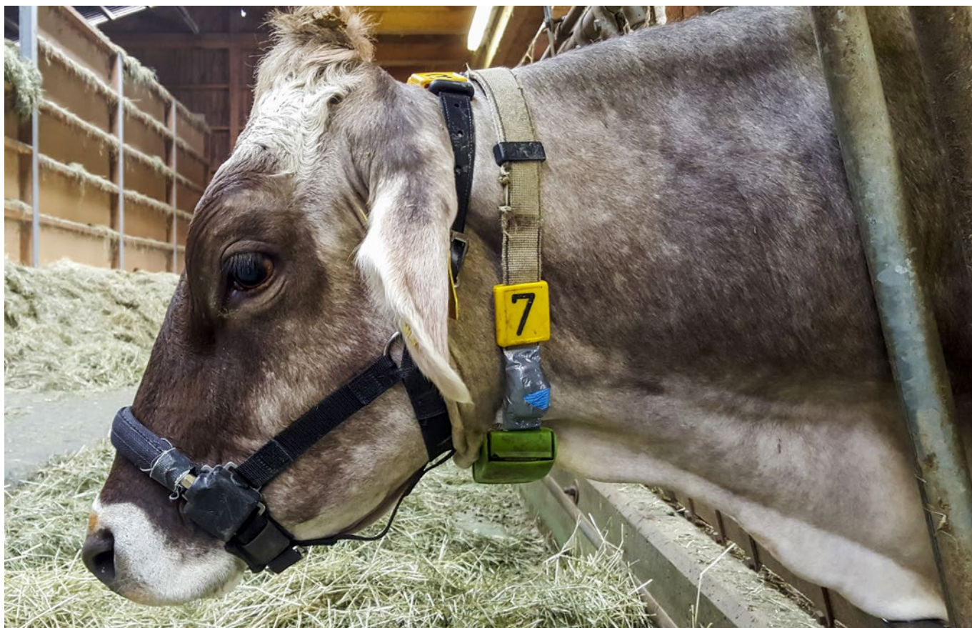
Abb. 4: Die Fress- und Wiederkauaktivität wurde durch ein Halfter mit Drucksensor im Nasenband aufgezeichnet. Am Halsband (zwischen Transponder und Halsbandnummer) wurde ein Beschleunigungssensor zur Erfassung der Halsaktivität angebracht (Foto: Joan-Bryce Burla, BLV).
