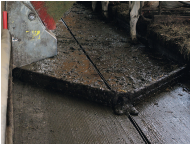
Abb. 6: Faltschieber in Vorwärtsfahrt (links). Kombischieber (rechts) in Rückwärtsfahrt.
