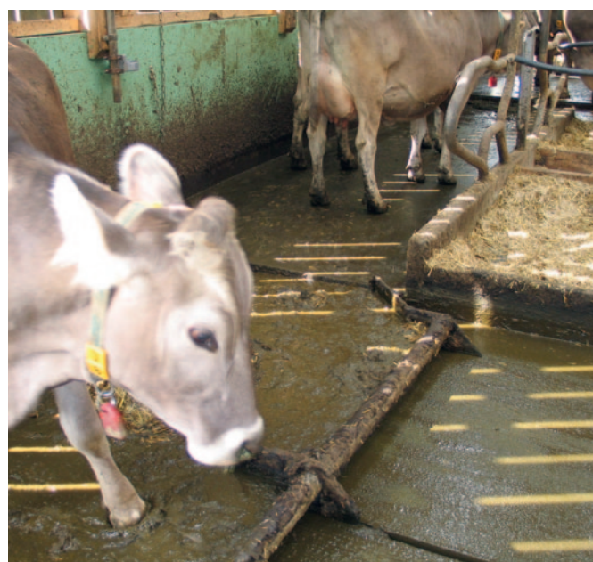
Abb. 7: Kombischieber mit grosser Mistpfütze. Sie führt zu einer starken Verschmutzung der Klauen und erschwert der Kuh die Einschätzung des Schieberumfangs.
