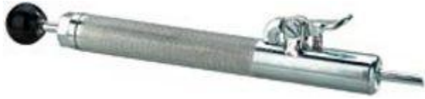
Abb. 2: Beispiel eines Federbolzen-Schussapparates
