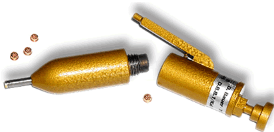
Abb. 3: Beispiel eines Bolzen-Schussapparates mit Patronen
